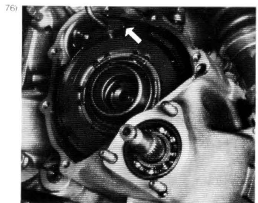
Mutter entsichern (Blechsicherung). Haltekeil Nr. T 030 250 einsetzen (s. Pfeil). Mutter entfernen (SW 17). Haltekeil paßt nur in Kupplungskorb mit entsprechender Aussparung.
