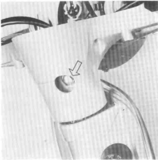
7) Bef.-Schraube des Lenkerkörpers (SW 13) lösen und herausnehmen
