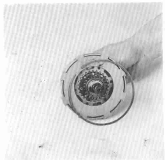
24) Wenn die Kupplungs-lamellen ausgewechselt werden, Kupplung mit Spannschraube entspannen, Seegerring ausfedern Werkzeug: Spannschraube (T 0020322)
