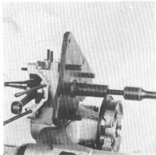
28) Kurbelwelle aus der linken Gehäusehälfte (Kupplungsseite) mit Werkzeug (T 0038886) herausdrücken.
