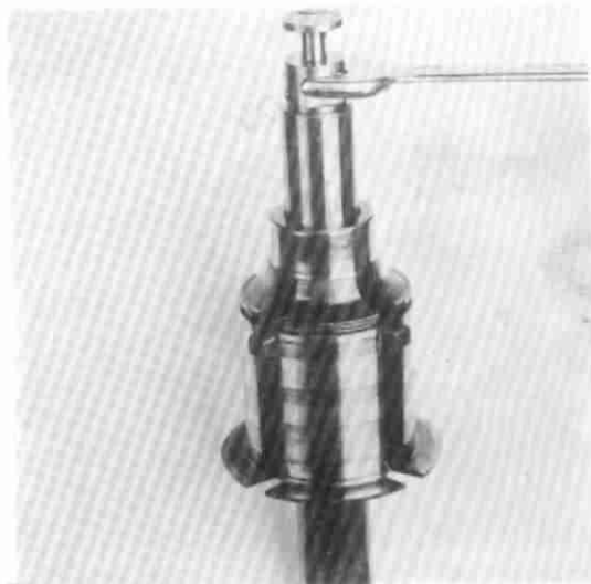
10) Wenn das Schaltkreuz ausgewechselt werden muß, Schaltkreuzwelle lösen ( Linksgewinde , SW 13)
