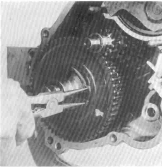
15) Schulterring und Seegerring montieren (Axiales Spiel zwischen den Zahnrädern 0,15-0,40 mm beachten)
