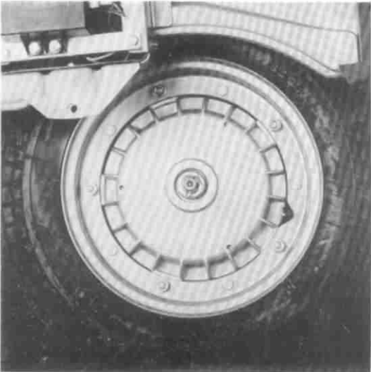
1) Abdeckkappe abnehmen, Kronenmutter entsplinten und abschrauben (SW 24) Hinterrad mit Bremstrommel abnehmen
