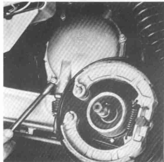
2) 3 Schrauben (Kupplungsdeckel) abschrauben (SW 10)
