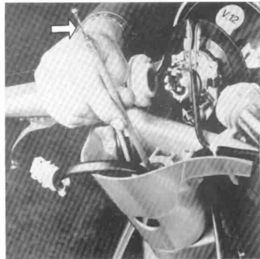
4) Alten Innenzug herausziehen Neuer Innenzug wird von oben in die Hülle eingeschoben
