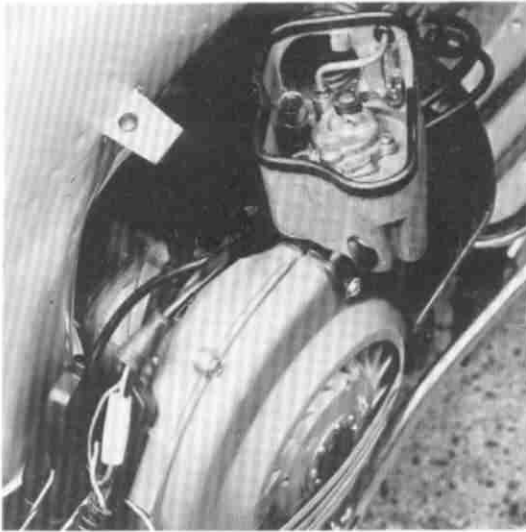
5) Schraube am Vergasergehäuse lösen. Vergasergehäuse abnehmen
