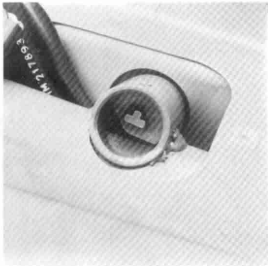
9) Die Verriegelung des Steuerrohres kann nur entfernt werden, wenn das Steuerrohr ausgebaut ist
