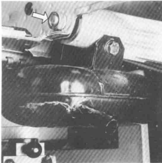
7) Traversenmutter lösen (SW 22)
