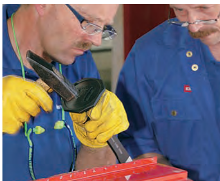
Bei widerspenstigen Schweißpunkten hilft Geis mit Hammer und Meißel nach
