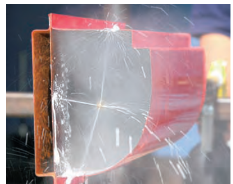
...bei der ersten Salzdusche auf diese Art in jeden Testschweller eingespritzt
