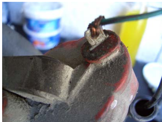
Defekter Bolzen wurde mit zweiter Mutter gesichert! Zündspule verdreht u. kein Anschlussstecker!
