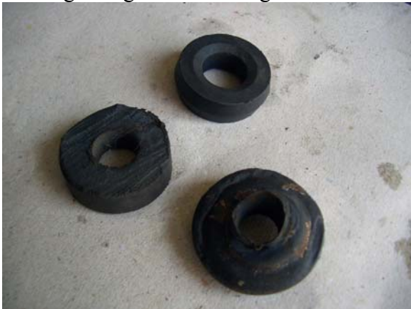
Selbst gefertigter Gummiring aus Schlauch! Original s.li. Bild oben und Bild rechts
