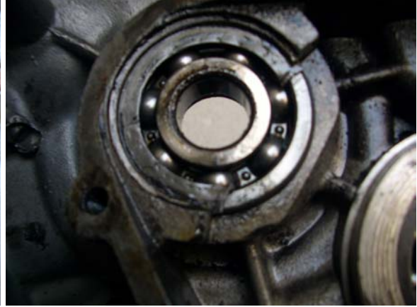
Lager wurde mit einem Stück Blech angepasst
