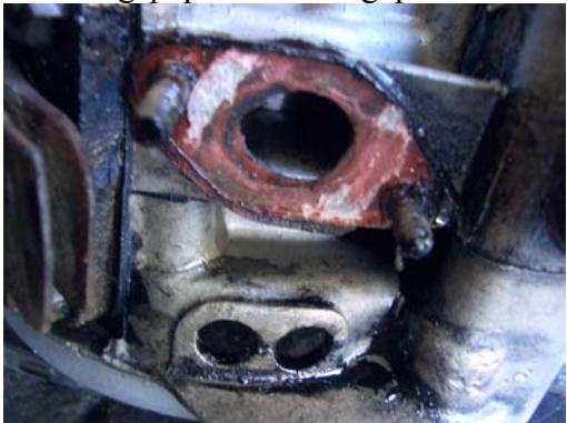
Defekter Bolzen wurde mit zweiter Mutter gesichert! Zündspule verdreht u. kein Anschlussstecker!
