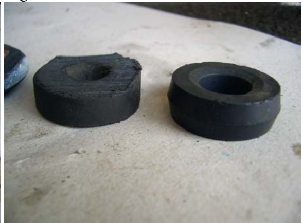
Selbst gefertigter Gummiring aus Schlauch! Original s.li. Bild oben und Bild rechts
