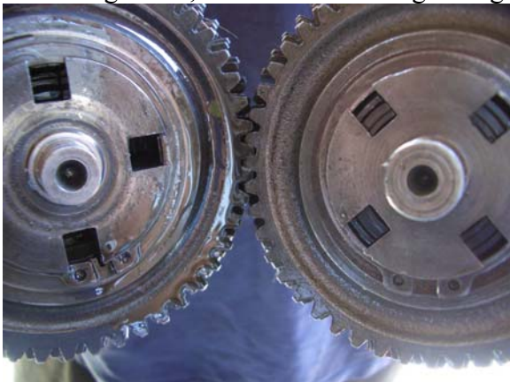
Welle abgedreht, weil ein anders Lager eingebaut wurde! Rechts das Original
