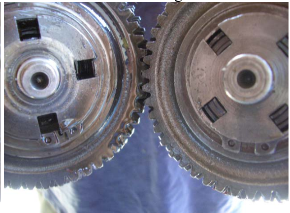
Welle abgedreht, weil ein anders Lager eingebaut wurde! Rechts das Original
