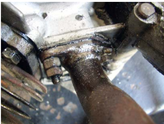
Defekter Bolzen wurde mit zweiter Mutter gesichert! Zündspule verdreht u. kein Anschlussstecker!
