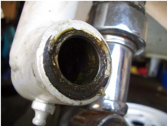
An der Vorderachse wurde eine Messingbuchse eingebaut ! Original Lager auf Bild rechts!
