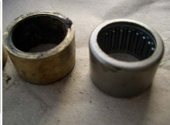
An der Vorderachse wurde eine Messingbuchse eingebaut ! Original Lager auf Bild rechts!
