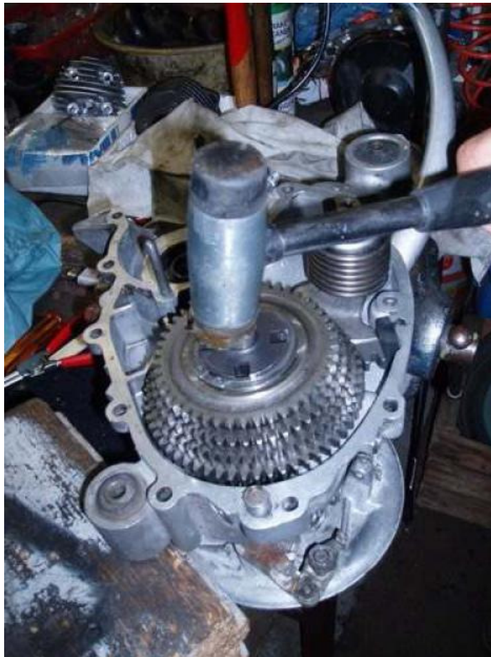
Getriebe mit Kunststoffhammer bis Anschlag reinklopfen.
