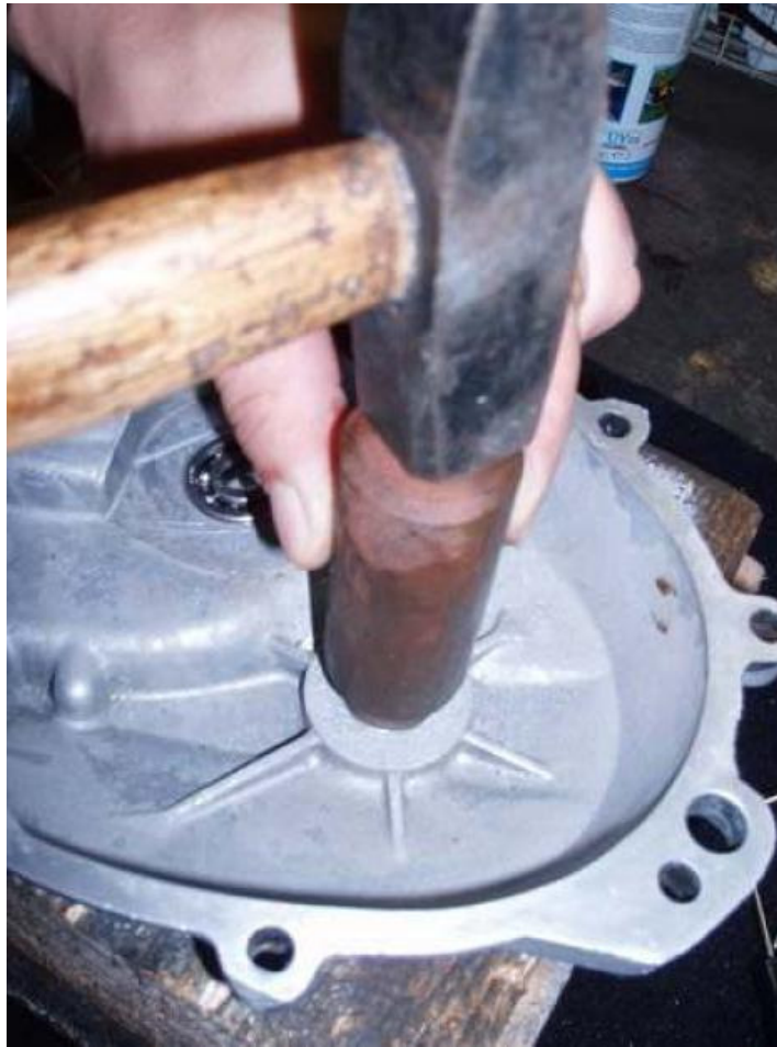
Lager bis Anschlag reinklopfen (Klangindikator)
