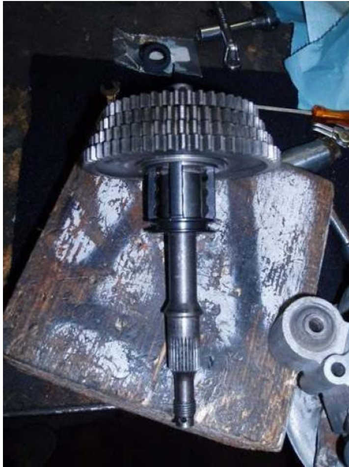
Das Getriebe mit neuer Schaltklaue
