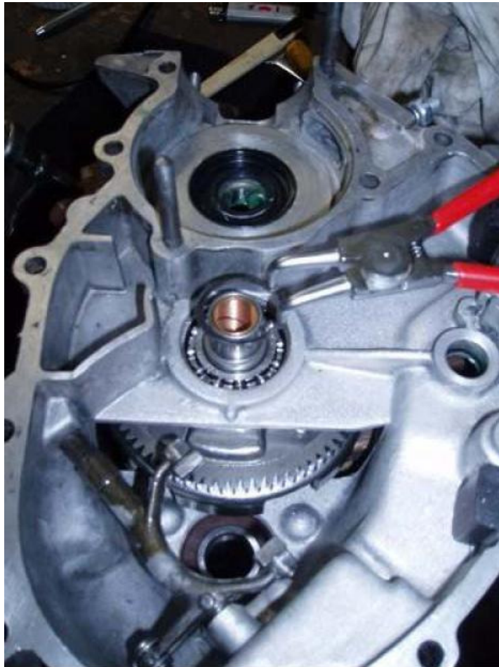
Das Primär wird ebenfalls mit einem Seegering gesichert. Seegering mittels Seegeringzange in die Nut des Primärs einbringen
