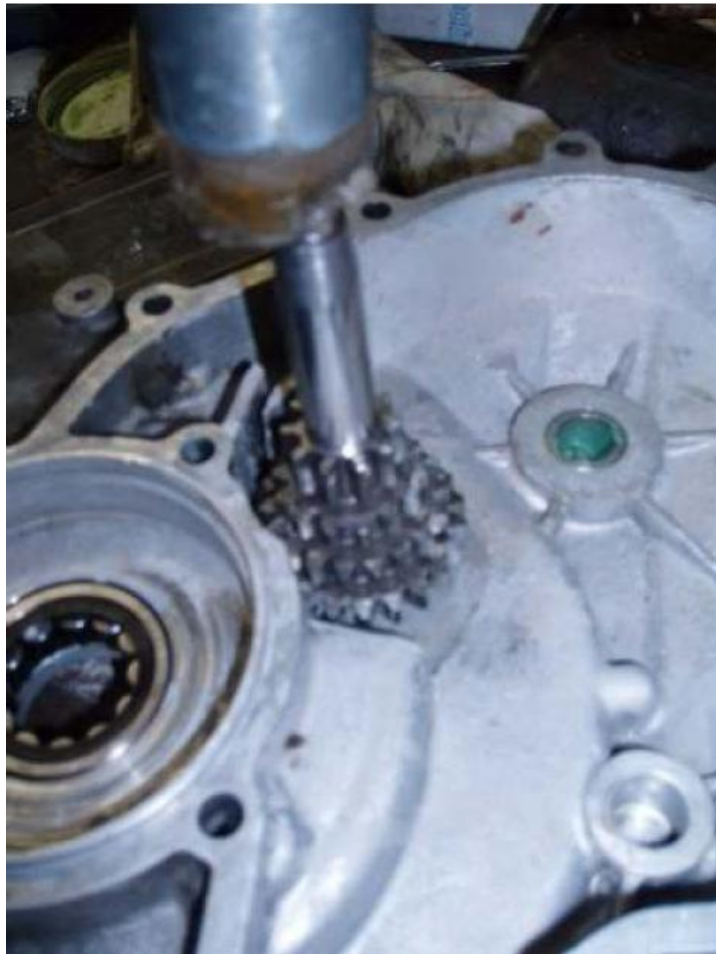
Nebenwelle mittels Kunststoffhammer reinklopfen
