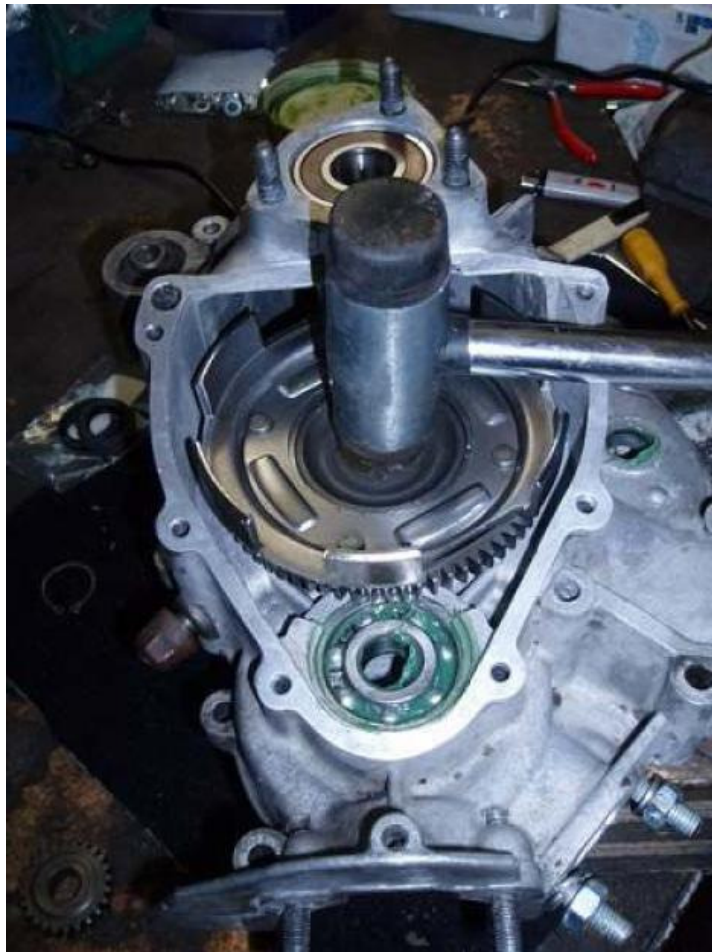
Primärtriebeübersetzung mittels KST-Hammer bis Anschlag reinklopfen
