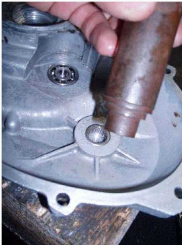
Gleicher Vorgang beim Hauptwellenlager (Nadellager). Erhitzen und anschl. Lager reinklopfen. Hier wurde eine Piaggio Lagereinbauhilfe verwendet.
