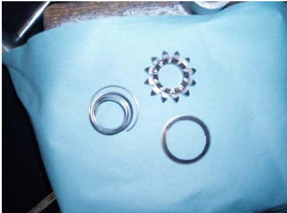
Kickstarterzahnrad, Schulterring, und Kickstarterfeder
