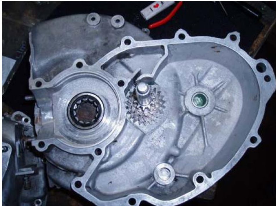
Kickstarteranschlaggummis mit Kunststoffhammer reinklopfen
