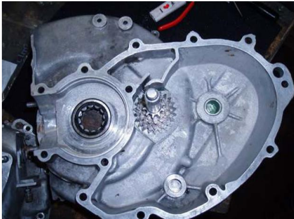
Zwischenstand 😊 Für Kurbelwellenlager LIMA-seitig wurde das 2-teilige NU204-Wälzlager verwendet - einbau 🡡 same story
