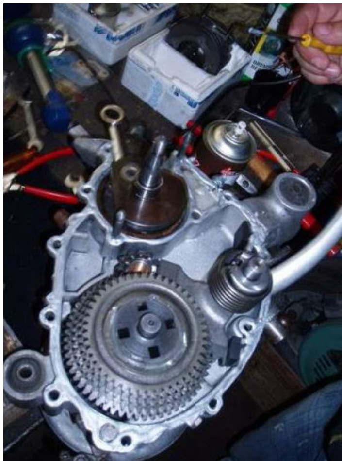
Dichtungsmasse (hier SILDAR) auf der entfetteten Dichtfläche gleichmässig verteilen. Kleiner Schraubenzieher eignet sich hierfür sehr gut.
