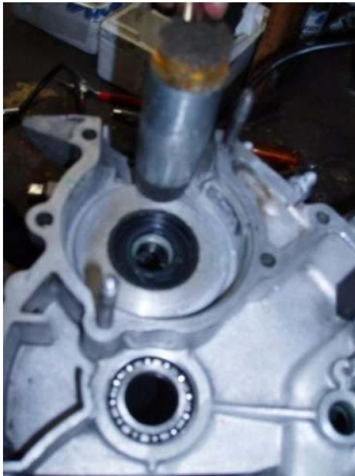
Simmering von Hand reindrücken. Merke: Feder zeigt immer zur Welle! Abschliessend vorsichtig mit Kunststoffhammer (Gummiseite bündig klopfen.)
