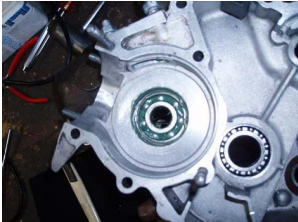
Kurbelwellenlager (KULU) hat keine zusätzl. Ölschmierung wie das LIMA-Lager. Daher fetten!
