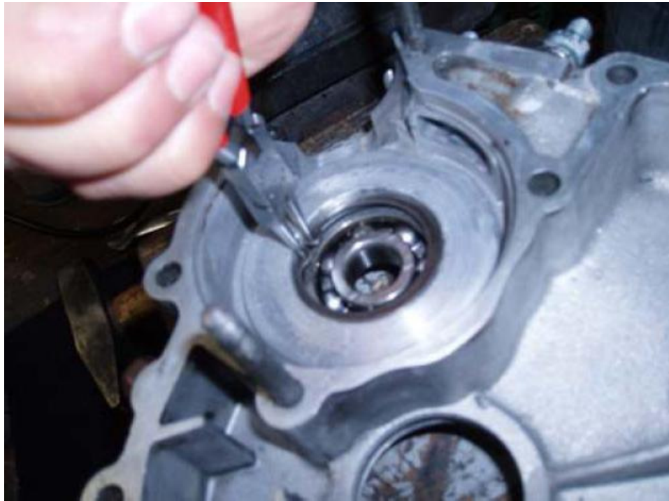
Mittels Seegeringzange wird der Seegering montiert
