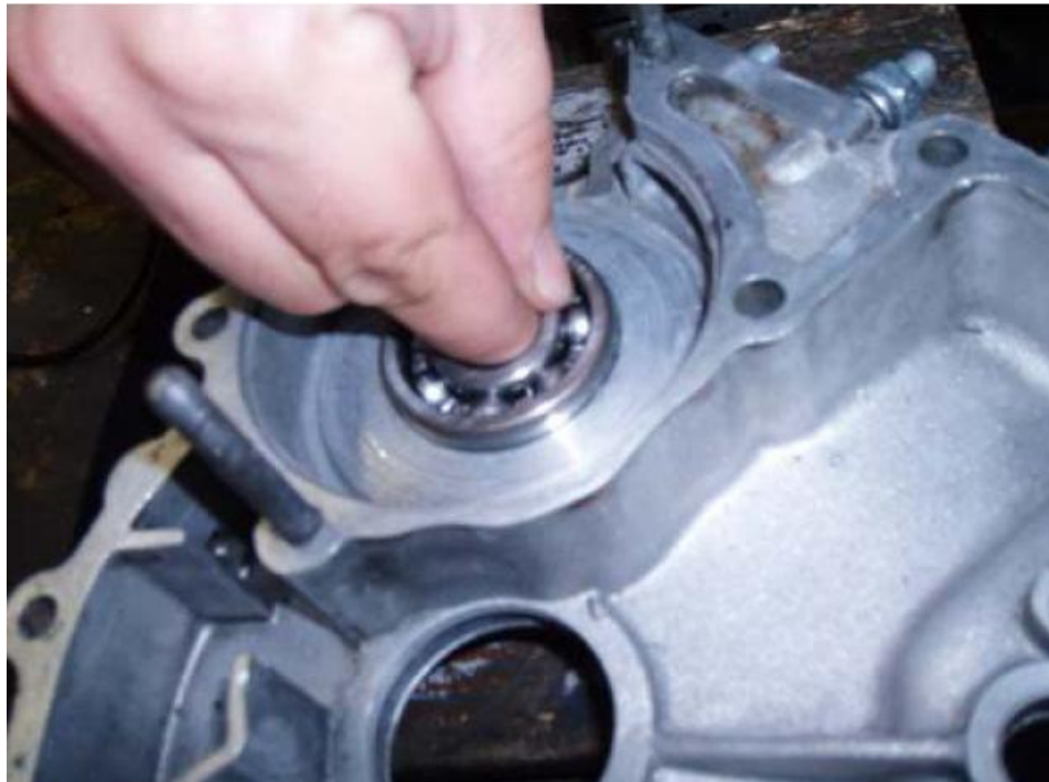
Der gleiche Vorgang wiederholt sich beim Kurbelwellenlager (Kulu). Wenn gut erwärmt wurde, plumpst das Lager fast von selbst rein.
