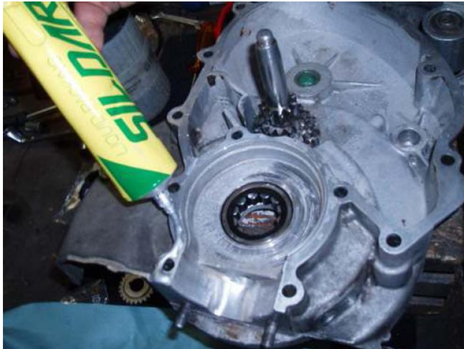
auch auf die zweite Blockschale wird Dichtmasse auf die Dichtfläche aufgetragen
