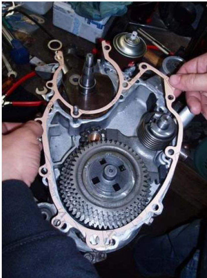
Dichtung auf die Schale geben
