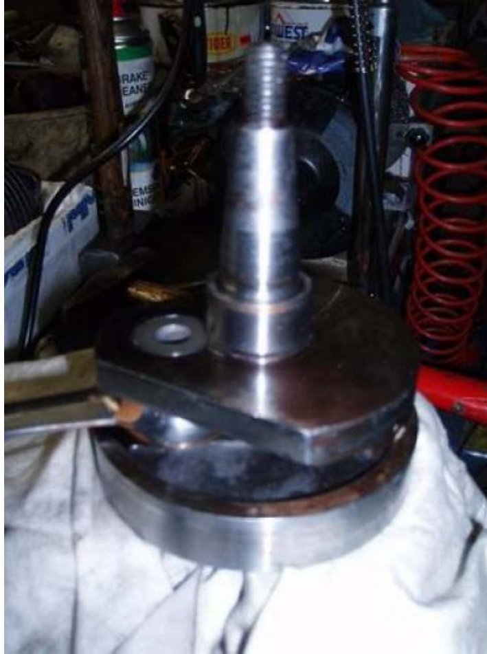
Ring mit Durchschlag und Hammer auf die Welle klopfen (Anschlag)
