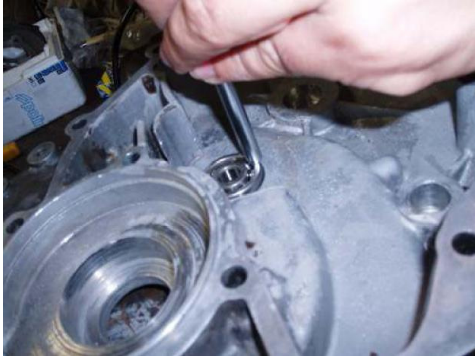
Mit einem Durchschlag und Hammer wird das Lager reinklopft. Man kann hierfür auch eine alte passende Ratschen-Nuß zum Reinklopfen hernehmen
