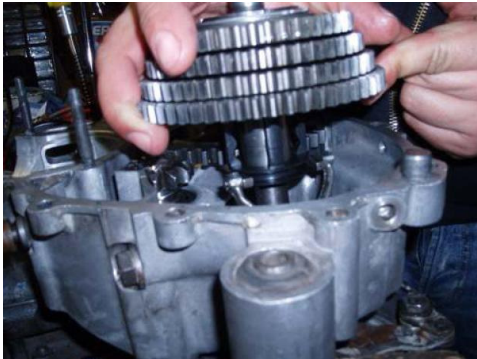
Schaltklaue ganz rausziehen und anschl. Schaltsteinchen in die Schaltklaue einfädeln
