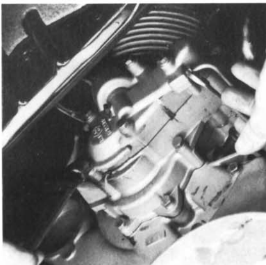
23) Schraube von der Ölleitung lösen und Leitung abnehmen. 5 Schrauben (SW 10) lösen und die Ölpumpe abnehmen.
