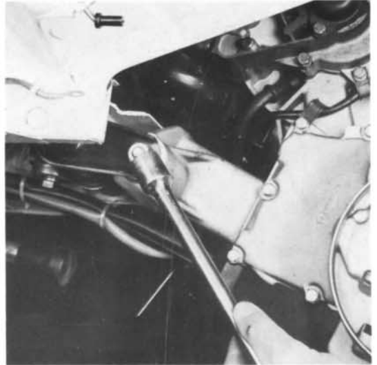
10) Traversenmutter lösen (SW 22).
