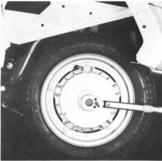
3) Mutter (SW 24) öffnen, Rad mit Bremstrommel abnehmen.
