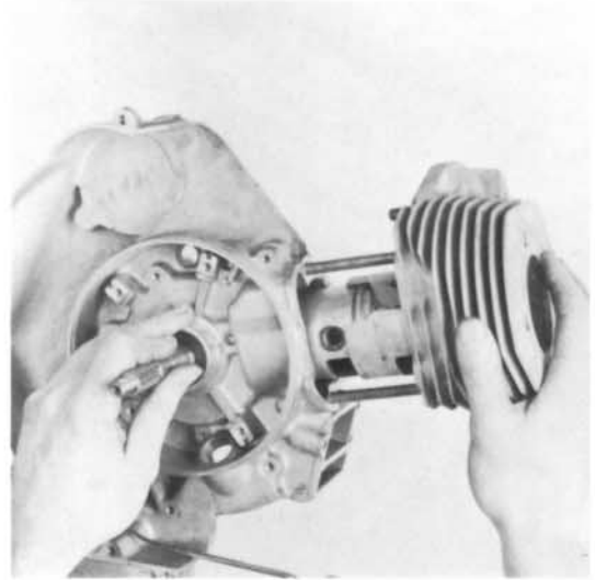
25) Fußdichtung und Zylinder montieren.
