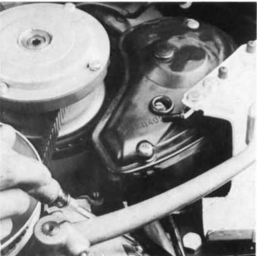
5) Kabelstecker abschrauben, Anschlußkabel der Lichtmaschine vom Kabelstecker trennen, 2 Schrauben lösen, Vergasergehäusedeckel abnehmen.
