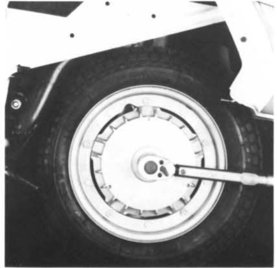
8) Kronenmutter entsplinten und abschrauben, Hinterrad mit Bremstrommel abnehmen.
