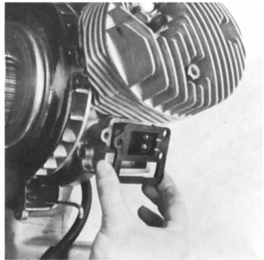
8) Membrankasten mit Dichtung abnehmen.
