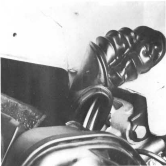
8) Gummiabsaugstutzen vom Gehäuse abziehen (Schelle lösen).
