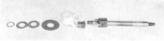
12) Steuerwelle einsetzen, Steuerwelle in Einzelteilen.
