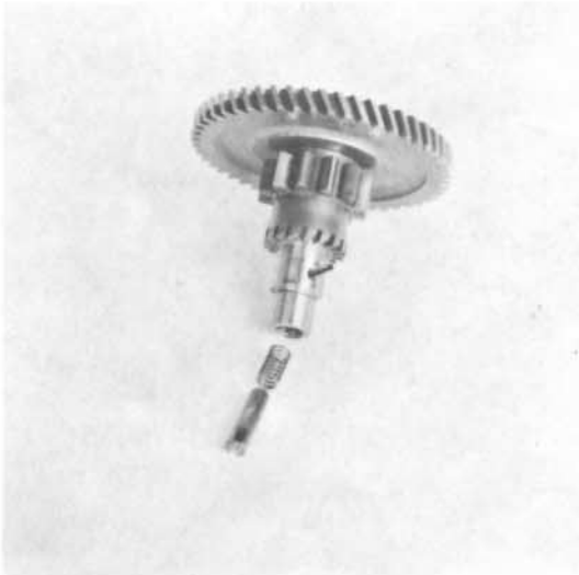
8) Feder mit Antriebswelle für die Hydraulikpumpe.
