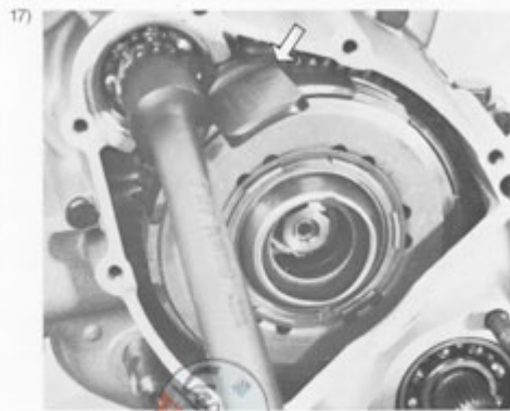
Mutter ensichern, Haltekeil Nr. T 030 250 einsetzen (s. Pfeil). Mutter lösen (SW 19).
