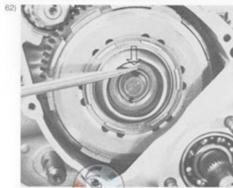
Druckplatte einziehen (Pfeil)
