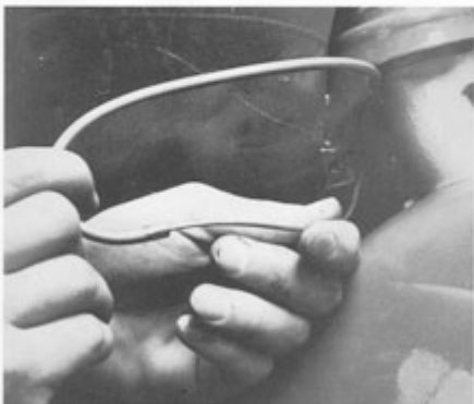
Stahldraht in die Hülle einführen. Hülle mit Führungsdraht nach oben schieben.
