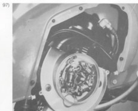
Zündeinstellung - Unterbrechereinstellung und Unterbrecherwechsel können vorgenommen werden.
