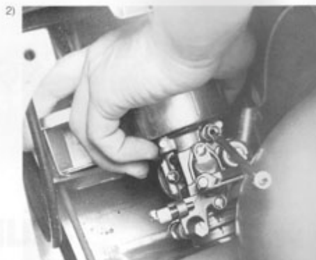
Gaszug aushängen, Schraube (1) lösen (SW 8). Vergaser durch leichtes Drehen vom Ansaugstutzen lösen.
