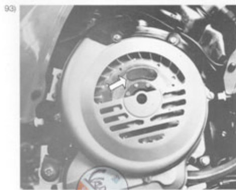
Lüfterdeckel abschrauben, Gummikappe abnehmen (s. Pfeil).
