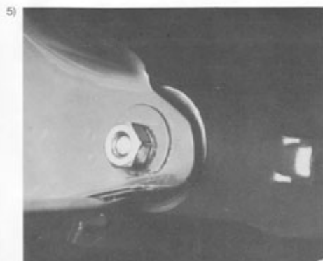
Traversenmutter lösen (SW 17).
