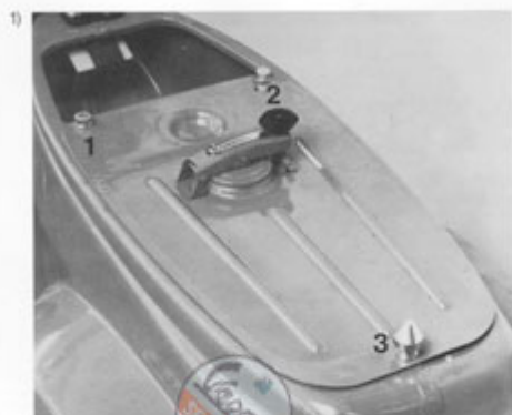
Sitzbank hochklappen, Schrauben (1-3) lösen (SW 11). Tank herausnehmen.
