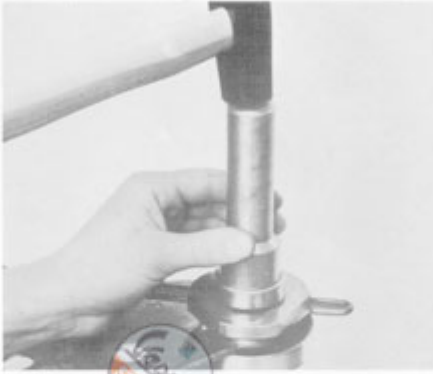
Lager auf Kurbelwelle montieren (Lichtmaschinenseite).
