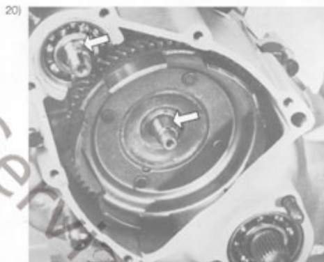
Keile entfernen (s. Pfeil).
