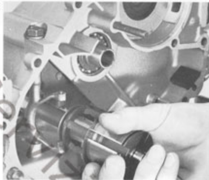
Antriebswelle aus den Schaltsteinen herausfädeln.
