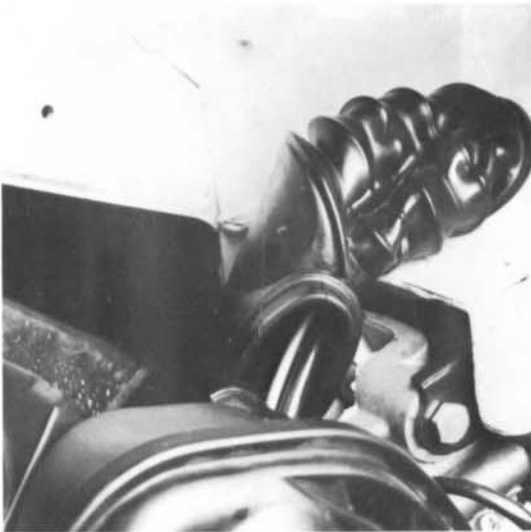
8) Gummiabsaugstutzen vom Gehäuse abziehen (Schelle lösen).
