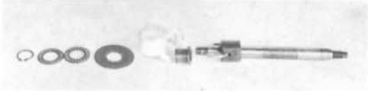
12) Steuerwelle einsetzen, Steuerwelle in Einzelteilen.
