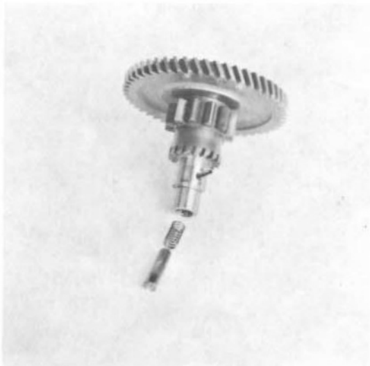
8) Feder mit Antriebswelle für die Hydraulikpumpe.
