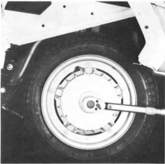
3) Mutter (SW 24) öffnen, Rad mit Bremstrommel abnehmen.
