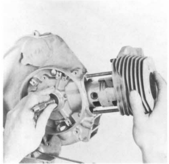
25) Fußdichtung und Zylinder montieren.
