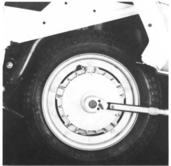
8) Kronenmutter entsplinten und abschrauben, Hinterrad mit Bremstrommel abnehmen.
