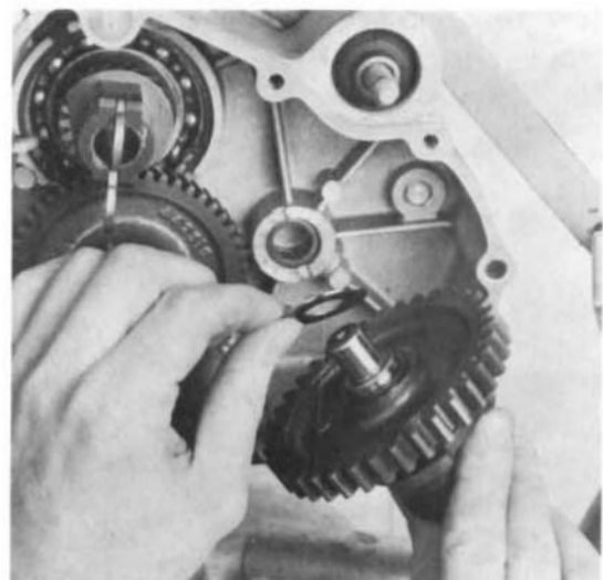
11) Scheibe montieren, Hinterachswelle einsetzen.
