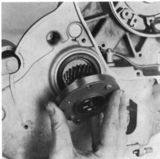
41) Freilauf und Zahnrad herausziehen.
