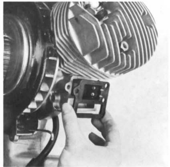
8) Membrankasten mit Dichtung abnehmen.
